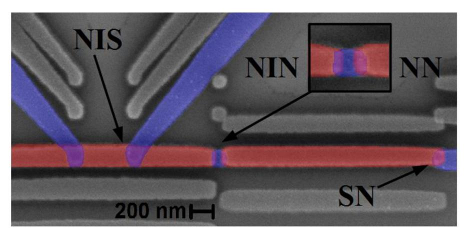
Al 20 nm / Cu 25 nm / 3mbar 3min Ox / Cu 25 nm
