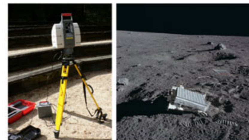
Esquerra: LIDAR per generar models 3D. Dreta: miralls dipositats a la Lluna en la missió Apollo 14, emprats per mesurar la distància Terra-Lluna per LIDAR.
