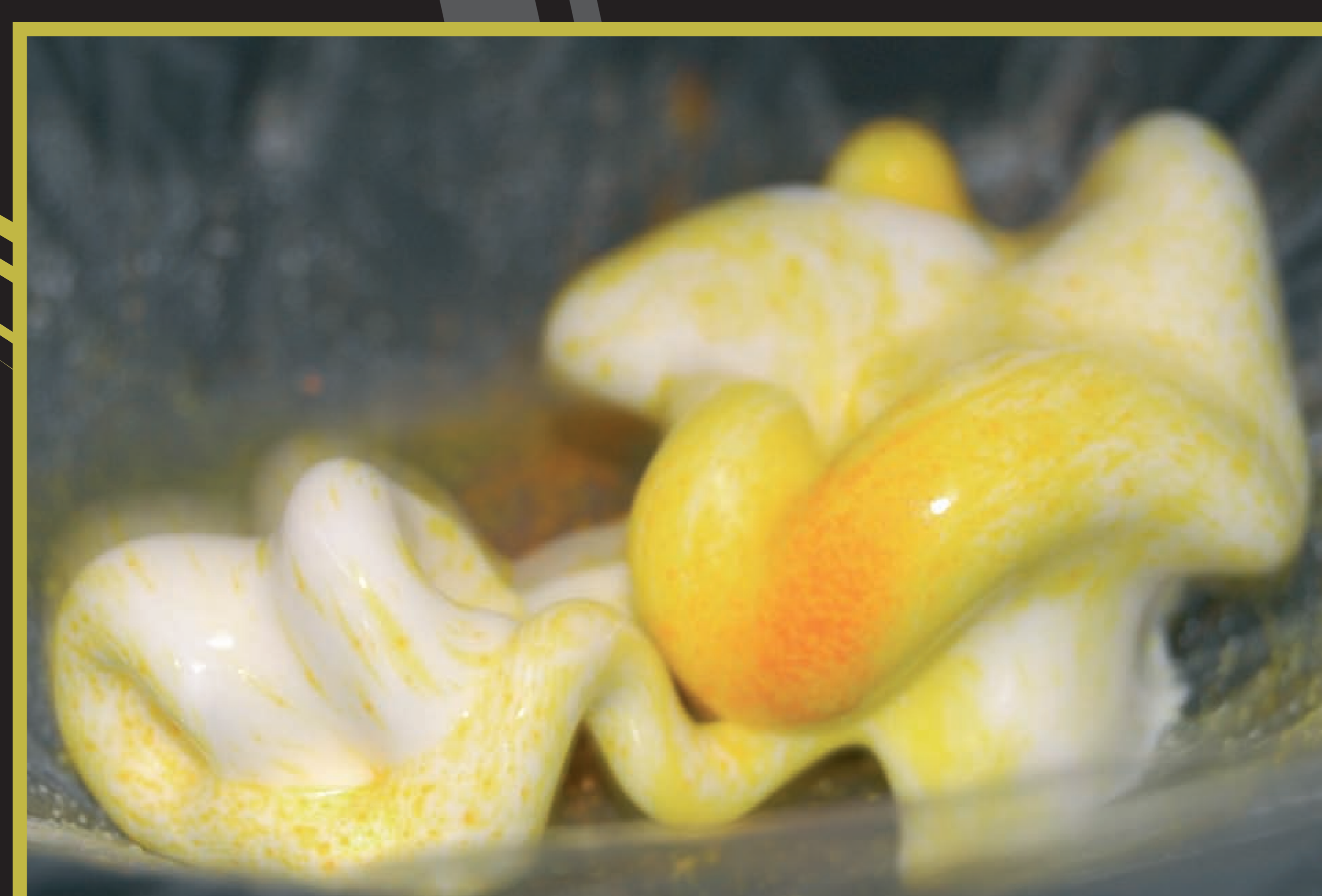
Vibracions molt intenses: estructures deslocalitzades com dits.
